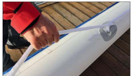
Des filières fixées de part et d'autre de la passerelle permettent de la manipuler plus facilement.
