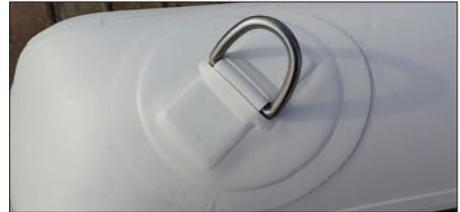
Quatre anneaux en inox sont placés à chaque extrémité de la passerelle, afin de la fixer à des bossoirs.
